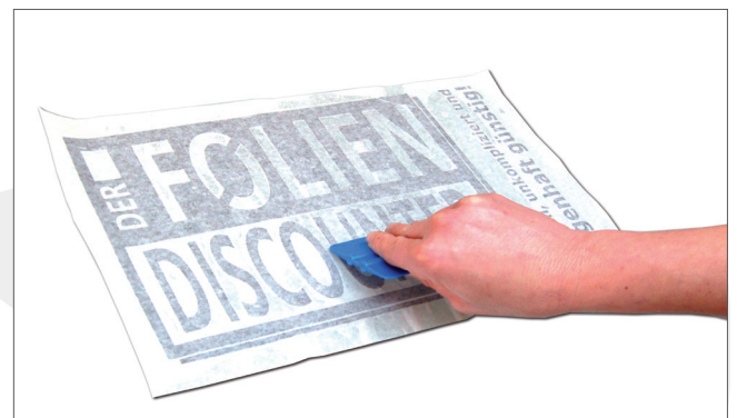
5. ...und mit dem Raker von der Mitte her nach aussen gut andrücken. Heraustretendes Wasser mit einem saugfähigen Tuch abtrocknen und den Folienrand nochmals gründlich andrücken.
