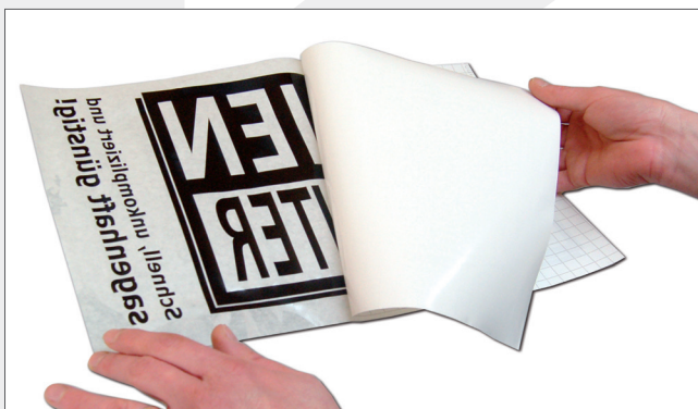
2. Folie mit Schutzpapier nach oben auf eine saubere Unterlage legen und Schutzpapier entfernen.
